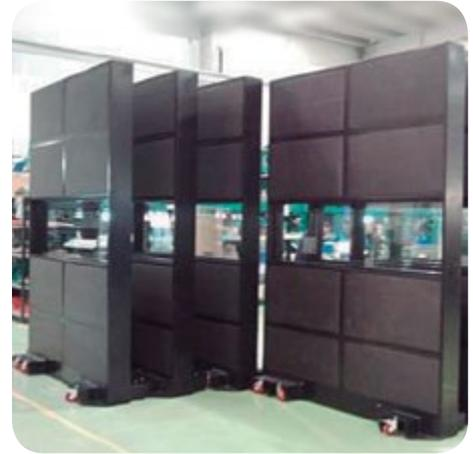
La pantalla móvil Cibel, esta compuesta de paneles acústicos machihembrados con material absorbente lana de vidrio en ambas caras, y bastidor metálico en perfil canal, más pie de apoyo similar al existente en terreno.
